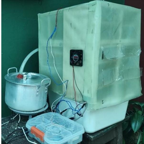
*Imagen 8. Prototipo final, generación de vapor, espacio para larvas MSN y un centro de control (Esp 32.).*
