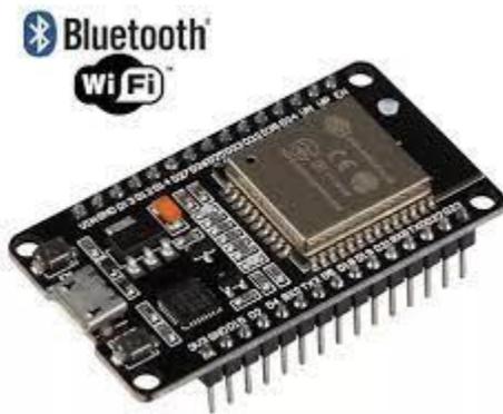
Imagen 6. Visualización del Micro controlador NodeMCU Esp 32
