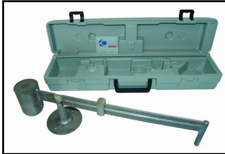
Figura 21. Balanza de lodo
