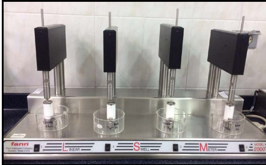
Figura 28. Lineal Swell Meter Model 2000
