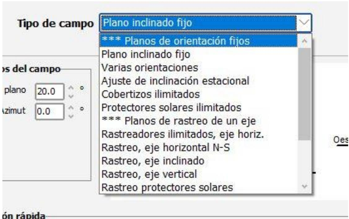
*Nota.* Se presentan los tipos de orientación a utilizar en un SSFV Tomado de Software PVsyst 7.3 versión Demo
