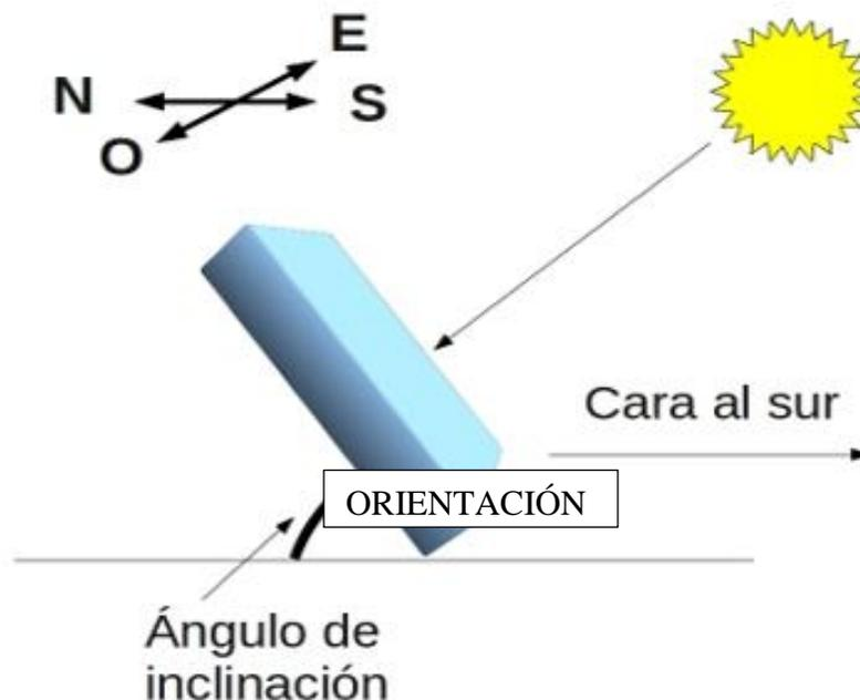
*Nota.* Representación gráfica de la inclinación y orientación de un sistema solar fotovoltaico ubicado en el hemisferio norte. Tomado de: <http://www.solesco.com.co/index.php/component/%20content/article/12-destacados/52-que-es-fotovoltaica-2>
