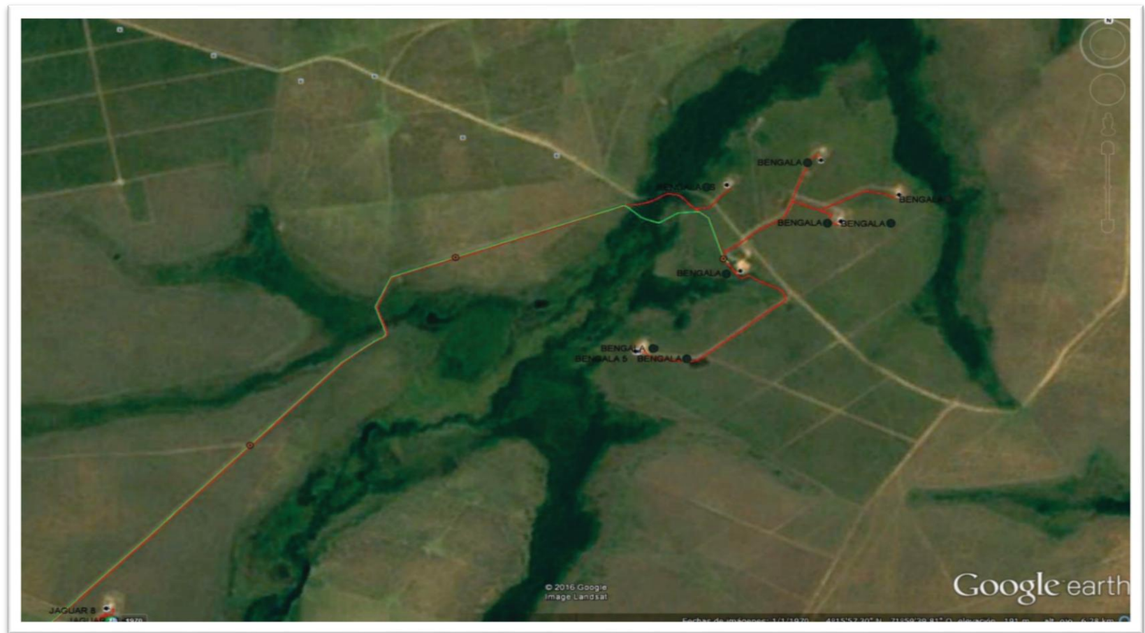
Figura 26. Imagen satelital de las líneas de flujo
