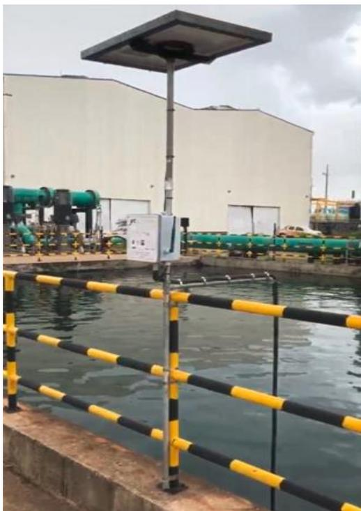
**Nota.** Equipo SWQ instalado en la piscina de permeado de la planta Saara
