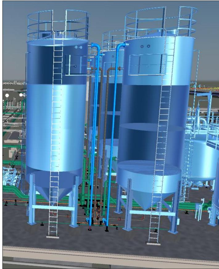
**Nota.** *Modelo 3D unidades de filtración y tanques decantadores. Tomado de: J. A. R. Cristian Hernández Ospina, Modelo 3D sistema de sostenimiento de presión, Navisworks, Puerto Gaitan, 2023.*
