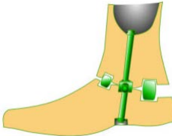
Figura 6. Articulación convencional de eje simple
