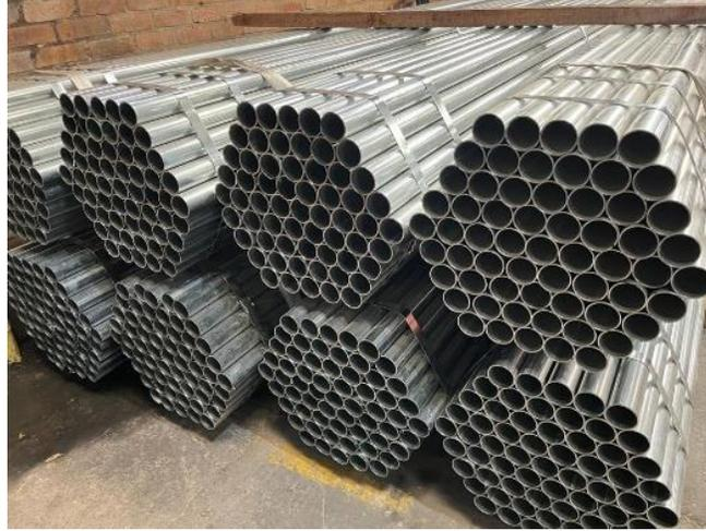
**Nota.** La imagen Muestra el formato y empaquetamiento de la tubería galvanizada, apilada en forma de paneles para una mejor distribución de peso.
