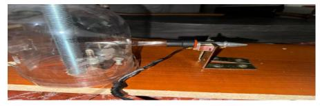
*Nota.* La figura identifica el calentador de silicona usado para el prototipo.
