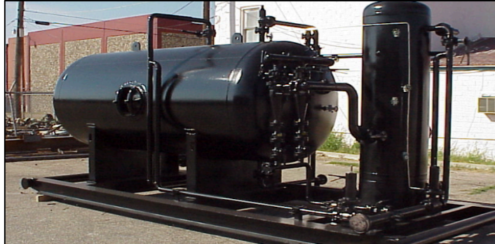
Figura 23. Tanque de almacenamiento y separador.
