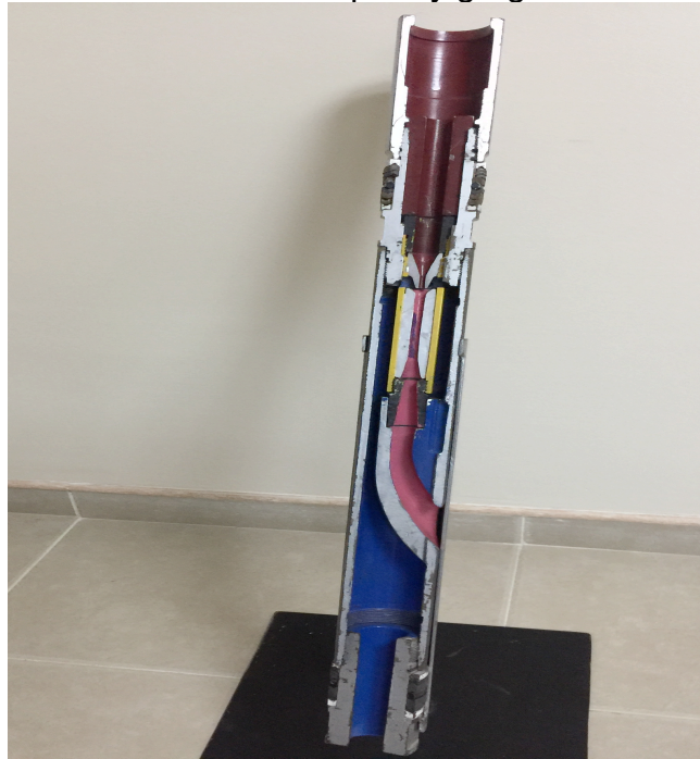
Figura 27. Instalación boquilla y garganta en directa.
