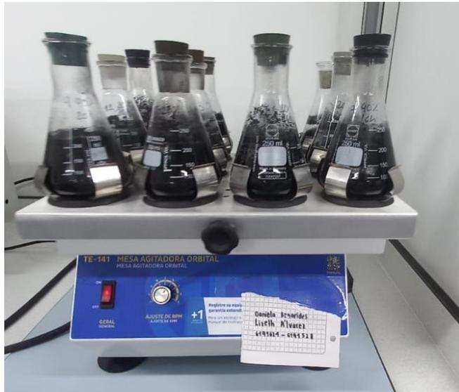
*Nota. La foto evidencia el momento en el que la materia prima previamente carbonizada es distribuida a los Erlenmeyer para ser activadas por medio de  $H_2PO_4$  en constante agitación*
