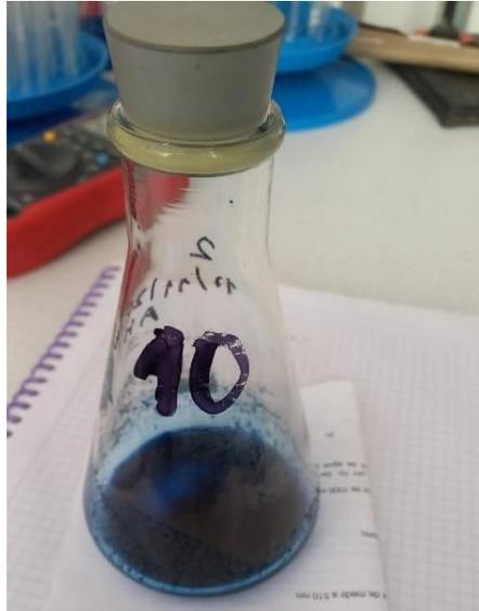
*Nota. La fotografía la adsorción presentado por el carbón activado desarrollado experimentalmente al estar en contacto con azul de metileno de concentración 1080.*
