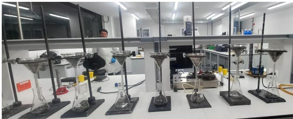
*Nota. Neutralización de los carbones activados con agua desionizada*
