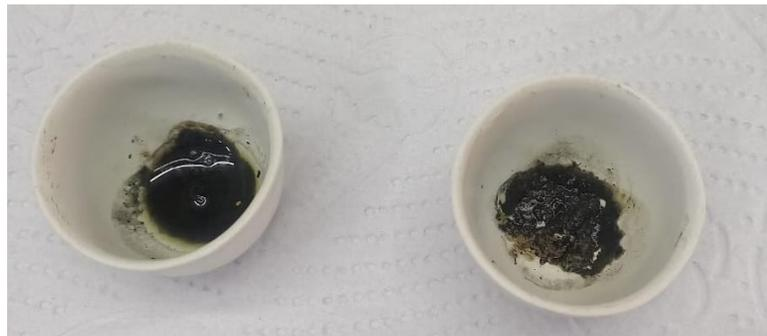
*Nota. La fotografía demuestra la presencia de carbonatos al añadirle gotas de HCl a las cenizas de la pulpa de café*
