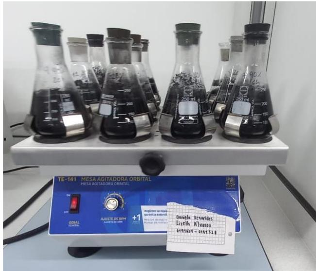
**Nota.** La foto evidencia el momento en el que la materia prima previamente carbonizada es distribuida a los Erlenmeyer para ser activadas por medio de  $\text{H}_2\text{PO}_4$  en constante agitación
