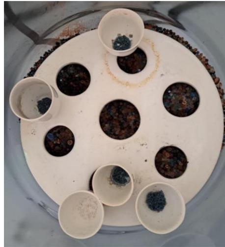
*Nota.* Cenizas de coloración verdosa lo cual puede ser debido a contenido de cobre en la pulpa de café
