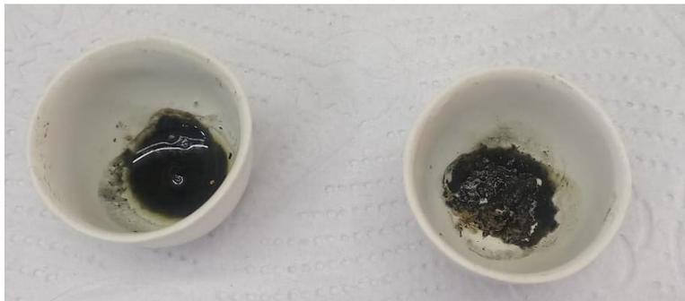
*Nota.* La fotografía demuestra la presencia de carbonatos al añadirle gotas de HCl a las cenizas de la pulpa de café
