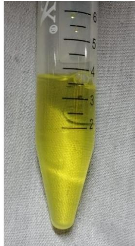
*Nota.* Evidencia fotográfica del ensayo de ausencia/presencia de cobre en las cenizas.
