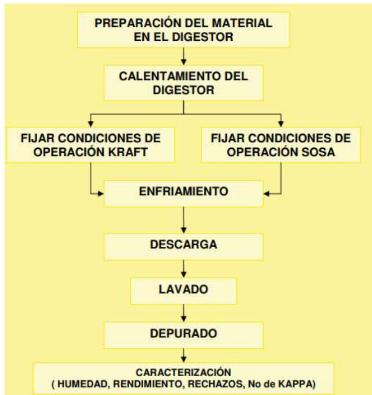
Figura 8. Proceso de cocción
