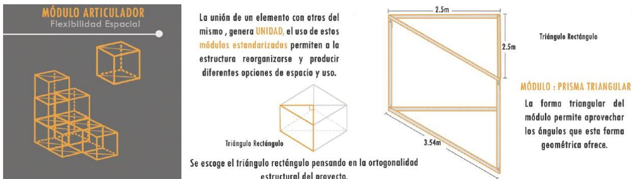
*Nota.* La figura muestra esquemas descriptivos donde la figura triangular se convierte en una forma clave para generar los módulos del proyecto.
