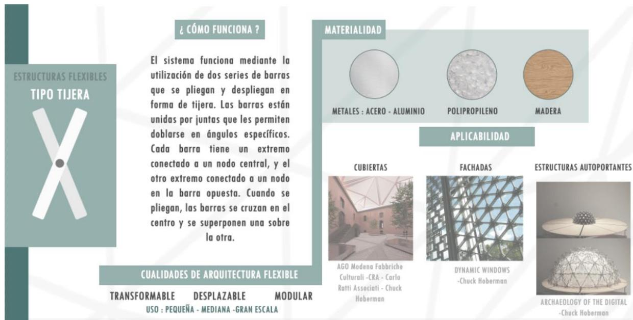
**Nota.** La figura muestra Funcionamiento de las estructuras tipo tijera, materialidad y aplicabilidad en el Arquitectura.
