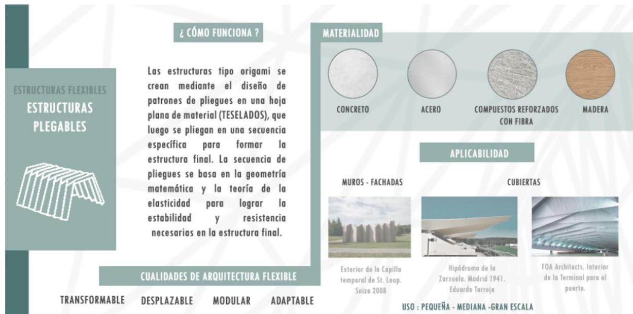
**Nota.** La figura muestra el funcionamiento de las estructuras plegables, materialidad y aplicabilidad en el Arquitectura.
