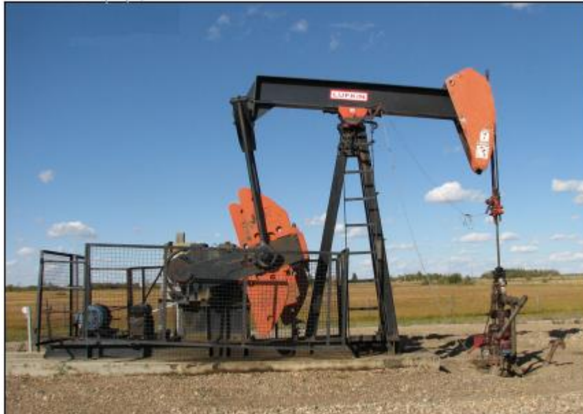
Figura 4. Unidad de bombeo en superficie Clase I
