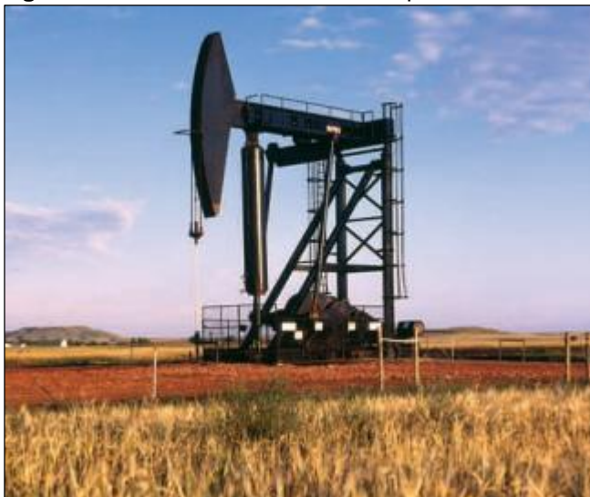
Figura 6. Unidad de bombeo en superficie Clase III
