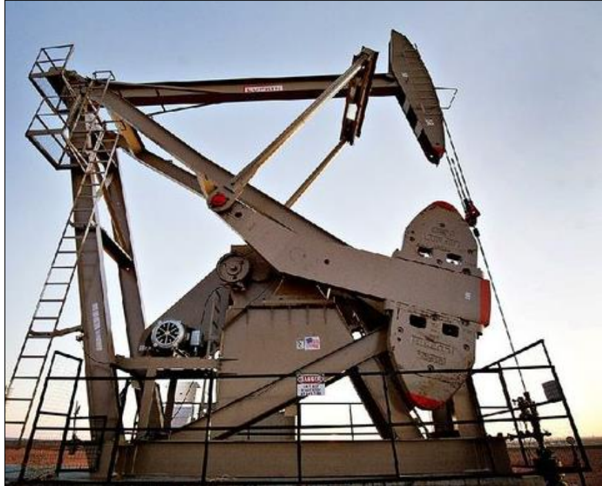
Figura 5. Unidad de Bombeo Mark II
