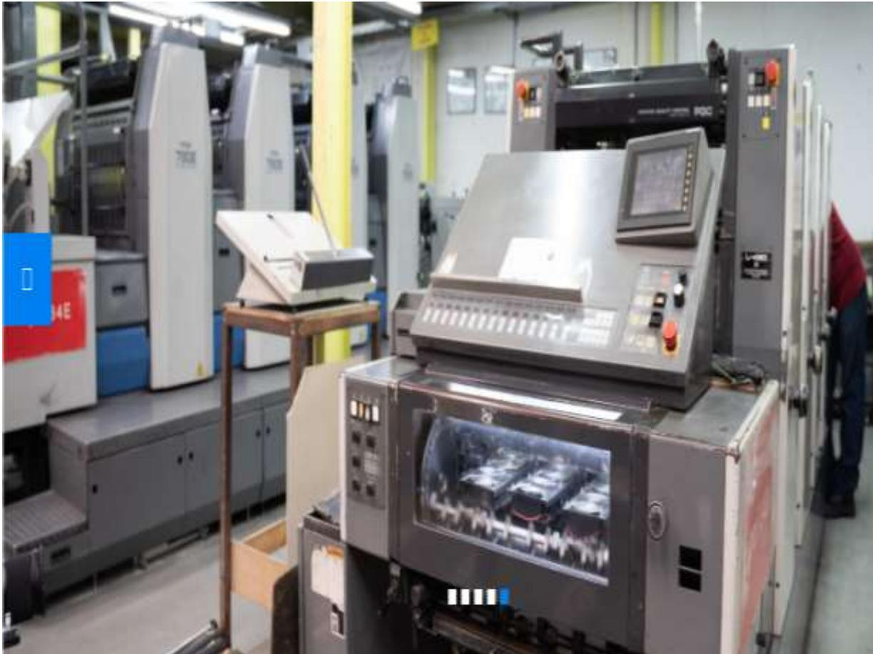
**Nota.** la fotografía muestra la máquina Komori Modelo 92 de pliego cuatro colores, utilizada para realizar impresiones offset. Información de Inversiones Tecnograficas SAS.
