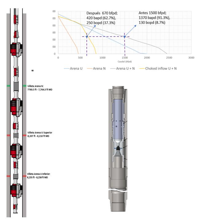
Nota: La figura representa el caso de éxito "Down Flow reductor" basado en la data de la Jet Smart MPLT del pozo piloto que se encuentra en el mismo campo petrolero, reduciendo el volumen de agua de 1370 a 420 BAPD, optimizando la producción de petróleo de 130 a 250 BOPD
