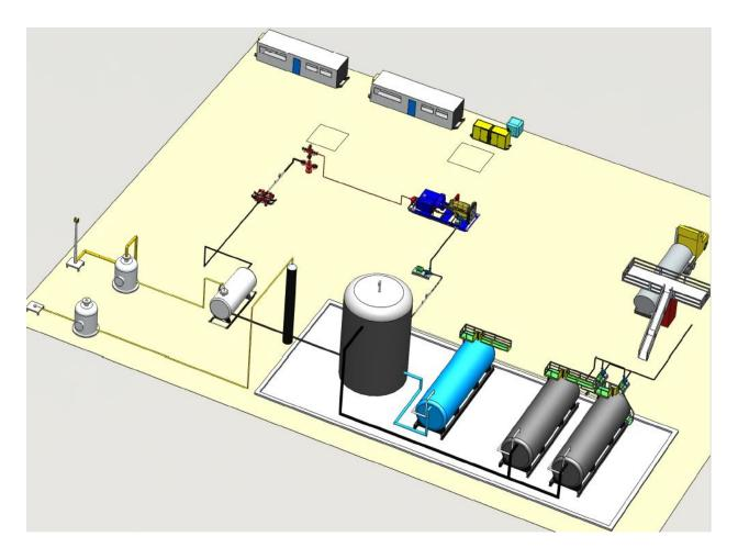
**Nota.** El grafico representa la distribución de equipos de superficie del sistema de bombeo hidráulico, tomado del manual de operaciones de Sertecpet S A (Sertecpet SA, 2016)
