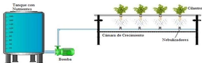
*Nota.* Relación de sistema básico aeropónico y sus componentes. Tomado de Ruiz, G. A. (2019). *Diseño e implementación de un sistema de control de riego para prototipo automatizado de cultivos aeropónicos de cilantro.* Ibagué, Colombia. Pg. 18.
