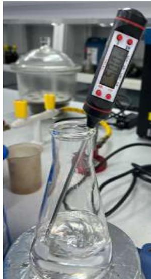
*Nota.* La figura muestra el solvente siendo elevado a una temperatura de 50° Celsius para ser agregado al sustrato.
