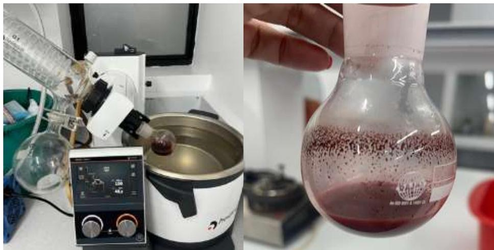
*Nota.* La figura muestra el sustrato en el rotaevaporador para retirar el solvente del sustrato.
