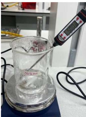
*Nota.* La figura muestra el solvente siendo elevado a una temperatura de 50° Celsius para ser agregado al sustrato
