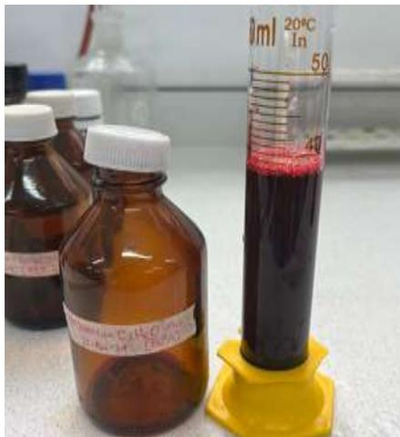
*Nota.* La figura muestra el sustrato luego de pasar por el rotaevaporador para retirar el solvente.
