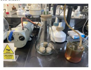
**Nota.** Después de la primera saturación con agua de formación se generó vacío en el Erlenmeyer nuevamente mientras se suministraba lentamente el crudo para saturar los cuatro núcleos.
