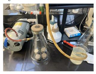
**Nota.** Se generó vacío en el Erlenmeyer durante una hora con una bomba mientras se suministraba lentamente la muestra de agua de formación para saturar los cuatro núcleos. Este proceso se realizó antes y después de la saturación con crudo para establecer la mojabilidad al agua en la roca.
