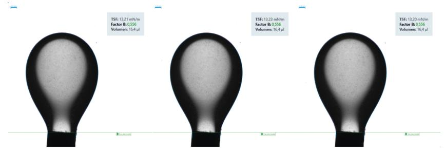
**Nota.** Imágenes de las gotas tomadas con el DSA para medición de la tensión interfacial entre agua de formación y crudo contaminado con filtrado de lodo con 5 Lb/Bbl de emulsionante. Se redujo la tensión interfacial a 13 mN/m.
