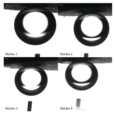
**Nota.** Imágenes capturada con el DSA de las mediciones individuales del ángulo de contacto por el método de burbuja cautiva con una gota de Fuel Oil, en un ambiente de agua destilada, en la superficie inferior de cada núcleo a condiciones iniciales.
