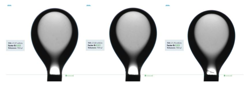
**Nota.** Con las capturas tomadas con el DSA se obtuvieron los resultados de la tensión interfacial entre las muestras de fluidos de formación sin contaminantes de la perforación. Los valores de la mediciones se aproximaron a 22 mN/m.
