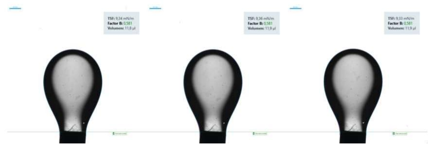
*Nota*. Imágenes de las gotas tomadas con el DSA para medición de la tensión interfacial entre agua de formación y crudo contaminado con filtrado de lodo con 8 Lb/Bbl de emulsionante. Se redujo la tensión interfacial a 9 mN/m.
