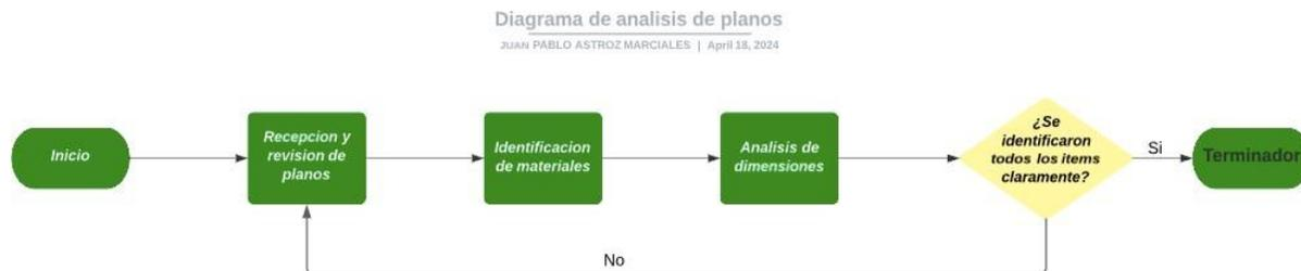
**Nota.** *diagrama que identifica el proceso de análisis de planos con el fin de identificar todos los factores del modelo*
