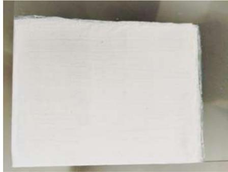
*Nota.* Prueba de secado de película en vidrio para evaluar la calidad de la pintura
