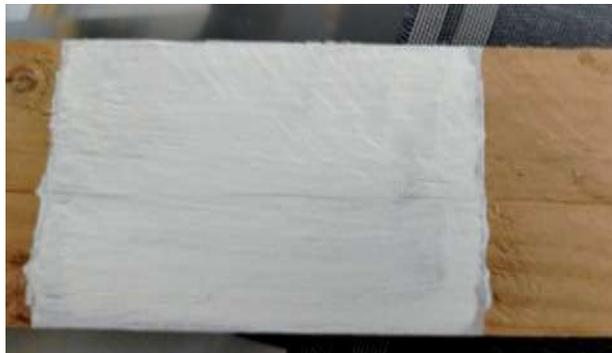
*Nota.* Prueba de secado de película en madera para evaluar la calidad de la pintura
