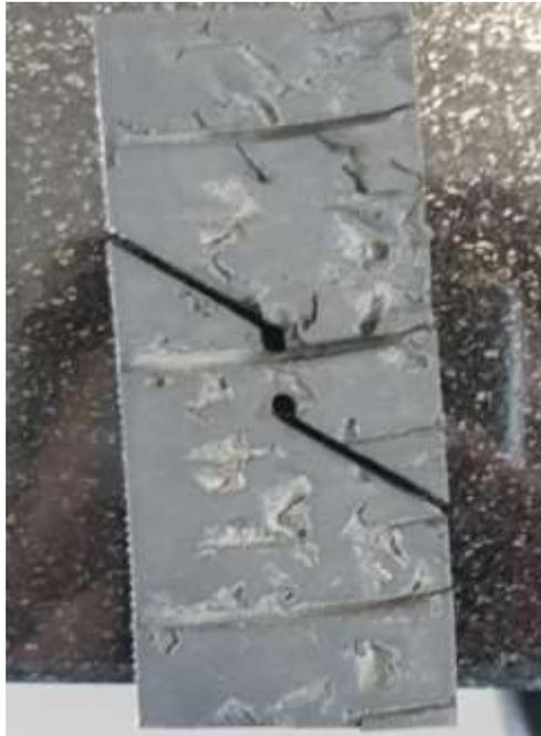
*Nota.* evidencia fotográfica, probeta para esfuerzo cortante.
