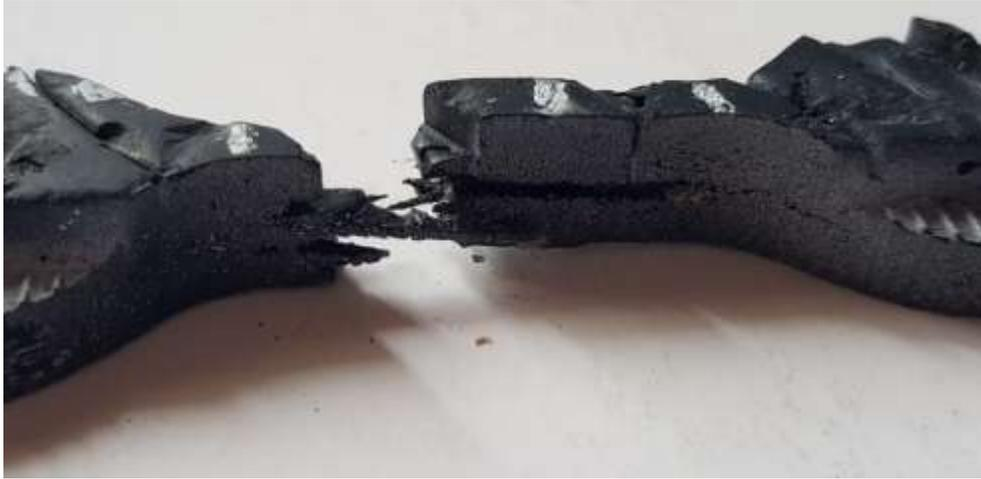
**Nota.** Foto tomada de probeta después de ser sometida a ensayo, se evidencia ruptura por capas
