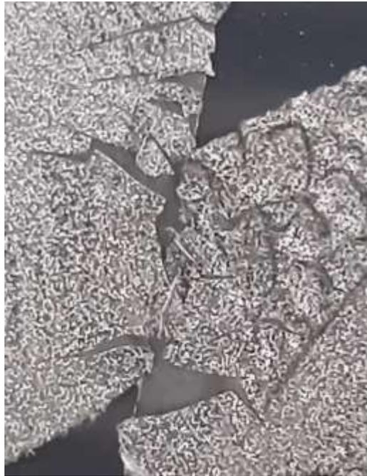
*Nota.* foto ampliada de probeta de esfuerzo cortante durante el ensayo de laboratorio
