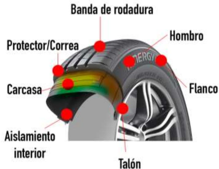
**Nota.** estructura del neumático y sus secciones, imagen tomada de Neumáticos KM0, [Online]. Available: <https://www.neumaticoskm0.com/estructura-de-un-neumatico/>. [Accessed: Aug. 05, 2024].
