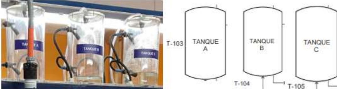
*Nota.* En la imagen anterior se observa una fotografía de los tanques A, B y C con sus respectivos símbolos en el diagrama P&ID.
