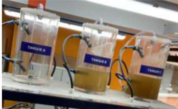
**Nota.** En la imagen anterior se observan los tanques A, B y C con residuos por oxidación de bomba 2.
