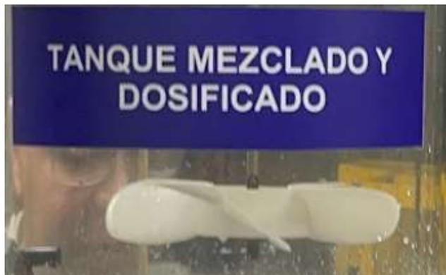
*Nota.* En la imagen anterior se observa una fotografía de las aspas nuevas montadas en el tanque mezclador.
