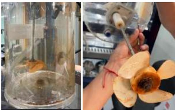
*Nota.* En la imagen anterior se observa una fotografía el estado inicial del tanque de mezclado y de su agitador.
