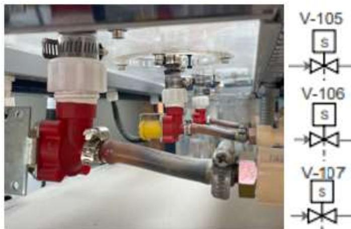
*Nota.* En la imagen anterior se observa una fotografía de las electroválvulas de dosificación y sus respectivos símbolos en el diagrama P&ID.
