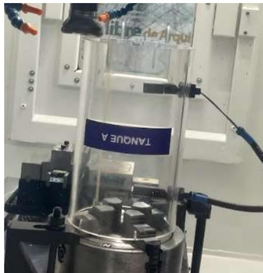
**Nota.** En la imagen anterior se observa una fotografía del proceso de refrentado del Tanque A en los laboratorios de la Universidad de América.
