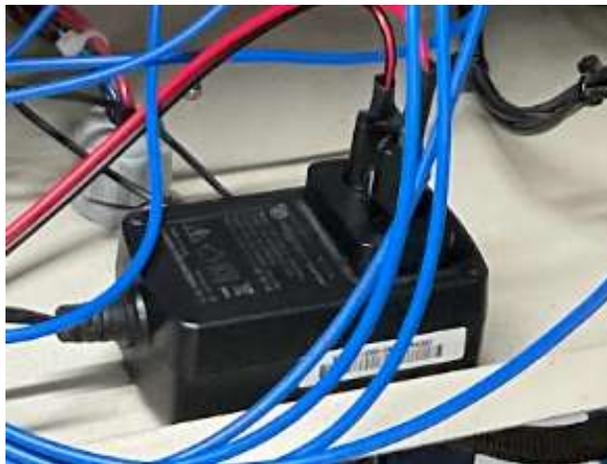
*Nota.* En la imagen anterior se observa una fotografía de la derivación realizada para obtener un voltaje de 12V.
