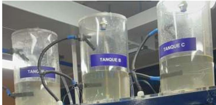
*Nota.* En la imagen anterior se observa una fotografía de la solución para la condición y apariencia que tenía el fluido por los residuos de corrosión.
