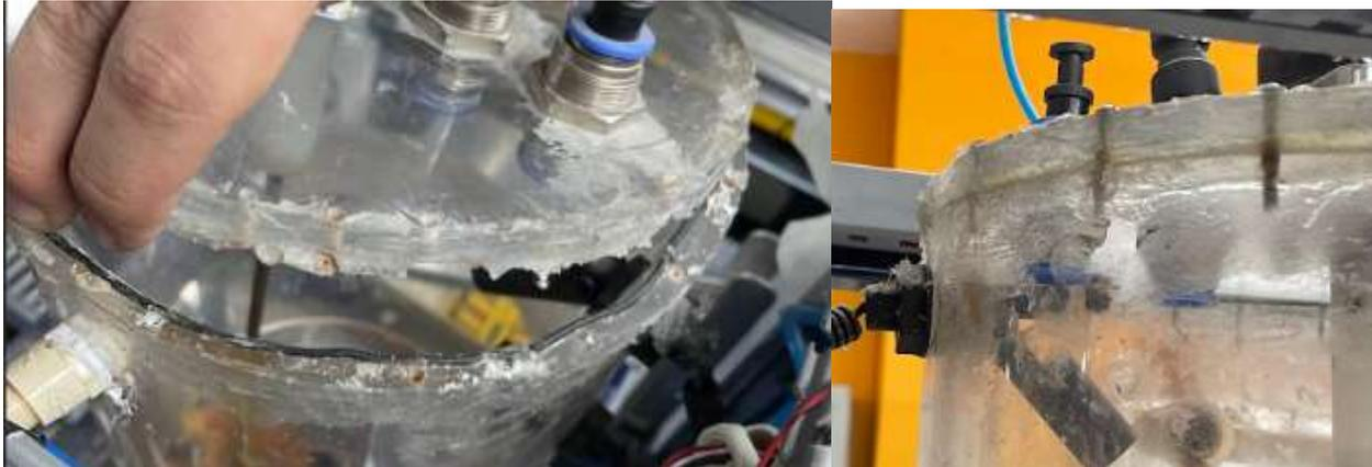
*Nota.* En la imagen anterior se observa una fotografía del exceso de silicona que presentaba el tanque de mezclado.
