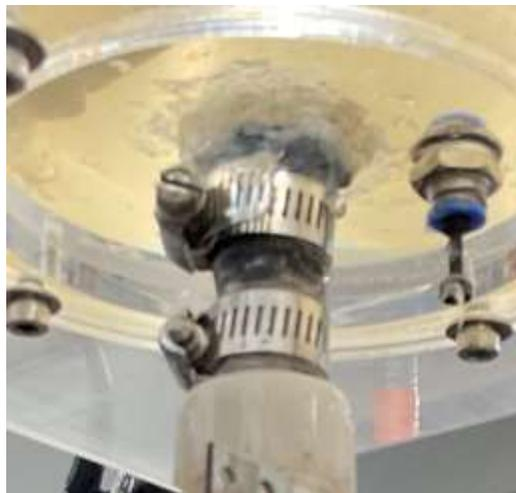
*Nota.* En la imagen anterior se observa una fotografía donde utilizan gran cantidad de silicona como método de sellado de los tanques de dosificación.
