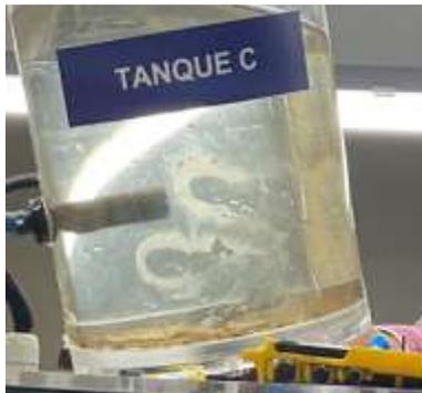
*Nota.* En la imagen anterior se observa precipitado de residuos de óxido en el tanque C.
