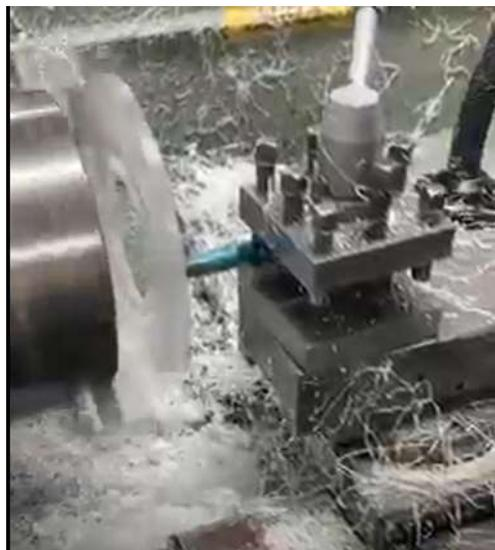
*Nota.* En la imagen anterior se observa una fotografía del proceso de Torneado de las bases de los tanques de dosificación.
