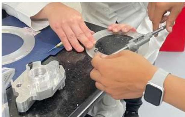
**Nota.** En la imagen anterior se observa una fotografía del proceso de roscado de las bases de los tanques.
