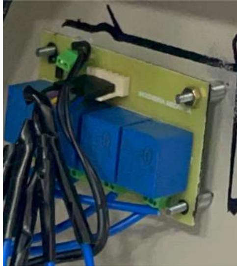
**Nota.** En la imagen anterior se observa el montaje de la PCB en la carcasa del equipo.
