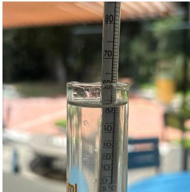
**Nota.** En la imagen se muestra la medición de los grados de alcohol utilizando un alcoholímetro de Gay-Lussac. Se observa que el etanol tiene una concentración del 54%.
