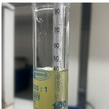
**Nota.** En la imagen se muestra la medición de grados de alcohol empleando un alcoholímetro de Gay – Lussac. El resultado muestra una concentración de alcohol del 40% después de destilaciones simples.
