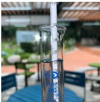
**Nota.** En la imagen se observa la medición de grados de alcohol utilizando un alcoholímetro de Gay – Lussac. El resultado muestra una concentración de alcohol del 62%, indicando un producto de alta pureza obtenido tras dos destilaciones simples.
