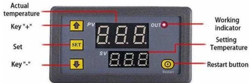
**Nota.** Controlador de temperatura de microcomputadora y sus principales características de funcionamiento. Tomado de: Twins Chip. Controlador de temperatura de microordenador digital. Disponible en. [https://www.twinschip.com/Digital\\_Microcomputer\\_Temperature\\_Controller](https://www.twinschip.com/Digital_Microcomputer_Temperature_Controller)
