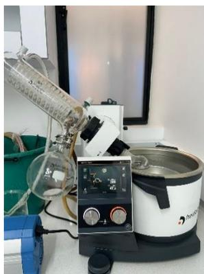
**Nota.** En la imagen se muestra el rotaevaporador que se empleó para realizar las destilaciones simples y extractivas.
