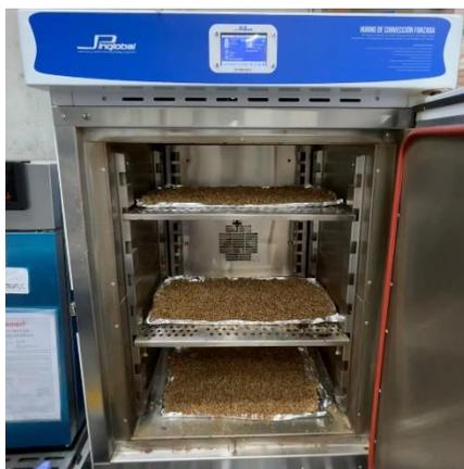
**Nota.** Afrecho de malta en proceso de secado a 70°C, previo a la hidrólisis ácida para la obtención de etanol.
