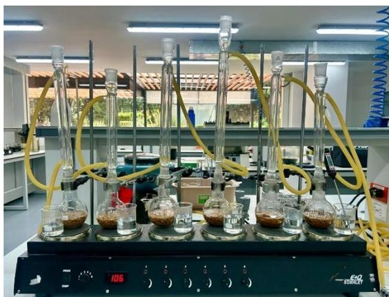
**Nota:** La figura muestra el montaje de reflujo empleado para realizar seis hidrólisis ácidas.
