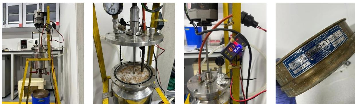
**Nota.** La figura muestra el montaje experimental empleado para realizar hidrólisis ácida en un reactor de tanque agitado continuamente (CSTR). El sistema cuenta con un sistema de calentamiento controlado por una resistencia eléctrica y un controlador de microcomputadora que permite ajustar la temperatura de reacción de manera precisa. Al finalizar la reacción, la mezcla resultante se filtra utilizando una malla para separar los sólidos de la solución líquida.
