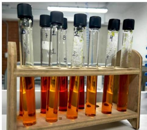
**Nota.** Se exponen las nueve muestras preparadas con DNS a partir de la solución intermedia 1 y solución intermedia 2, para la construcción de la curva de calibración de Glucosa.
