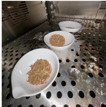
**Nota.** La imagen muestra tres capsulas que contienen 5 g de afrecho de malta en secado a 110°C durante 3 horas, como parte del análisis para determinar el contenido de humedad.
